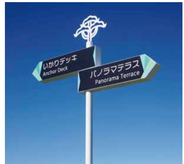
パネル部：W1000×H250 SUS 箱曲げ スーパーカラー R 印刷 オーナメント部分：φ320 mm SUS レーザーカット 支柱部：GLH3120 mm SUS 丸パイプ フッ素樹脂塗装
