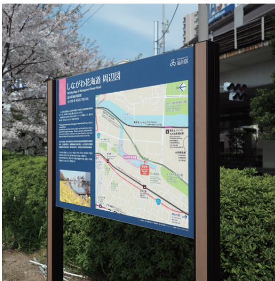
案件名：しながわ花海道 施主：東京都品川区 表示板サイズ：W1200×H900 表示方法：スーパーカラー R 本体素材：HR-1209 (アルミ押出型材+リサイクルウッド)
