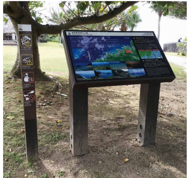
注意サイン（左）表示板サイズ：W95xH800 解説サイン（右）表示板サイズ：W418xH298 表示方法：スーパーカラー BR110 印刷
