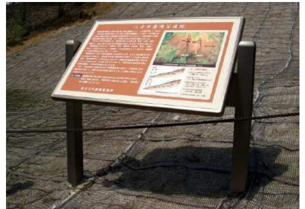
■ 布引運動公園サイン 本体：アルミ押出形材 印刷：スーパーカラー+ABコート
