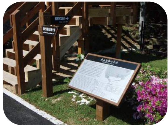
【解説標識】 本体：杉材 印刷：アボフォト 【誘導標識】 本体：杉材 印刷：スーパーカラーR+ABコート
