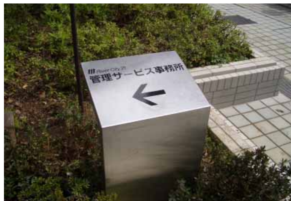
誘導板 YY-0003 表示板サイズ:400×300mm 表示方法:カッティングシート 本体素材:ステンレス
